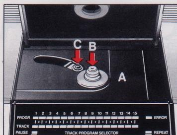
Potete pulire la lente dell'obiettivo del laser (C) con un batuffolo di cotone, imbevuto con acqua distillata, qualora si fosse formato un film sulla lente stessa. Evitate di esercitare pressione sull'obiettivo! Il pressore del disco che si trova sotto il coperchio incorpora un magnete. Assicuratevi che esso non attragga alcun oggetto di metallo.
