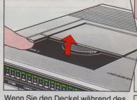
Wenn Sie den Deckel während des Abspielens versehentlich öffnen, wird die Platte dadurch gestoppt.
