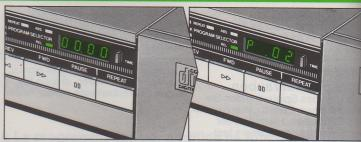
Beim Schnellsuchlauf für eine bestimmte Stelle wird Ihnen das Ablesen der relativen Zeit sehr dienlich sein, da sich nämlich der Anfang eines Stückes dadurch einfach finden läßt. Außerdem ist est möglich die Platte direkt vor dem Anfang zu stoppen indem man bei der Anzeige 'P .00' die Taste 'PAUSE' drückt.
