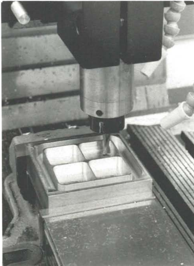
Figuur 2. Smalle sleuven en dunne wanden laten zich goed bewerken met hoogfrequent-frezen omdat de verspaningskrachten gering zijn als gevolg van het hoge spilttoerental.
