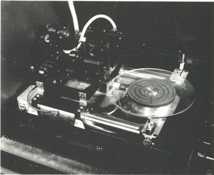
Figuur 3. Laser Beam Recorder voor het maken van moedermatrijzen voor laserdiscs (Compact Disc, Laservision en CD-ROM). Zichtbaar zijn de glazen masterdisc en de luchtgelagerde slede met de schrijfpotiek. Door de combinatie van mechanica, elektronica en optica is een uniek produkt ontstaan.
